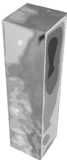
図 4.25 単体角柱の瞬間圧力分布
