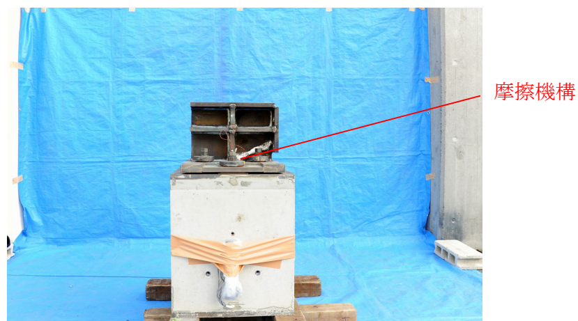
写真 5.2(c) 支承実験 試験体(全体)
