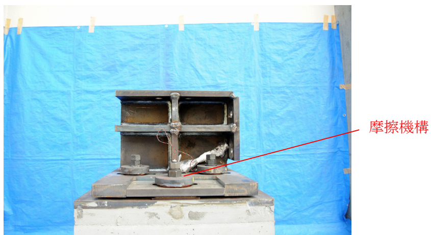
写真 5.2(b) 支承実験 試験体(支承部)
