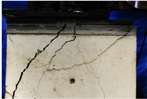
(b) RC部ひび割れの様子 (180kN 加力時)
