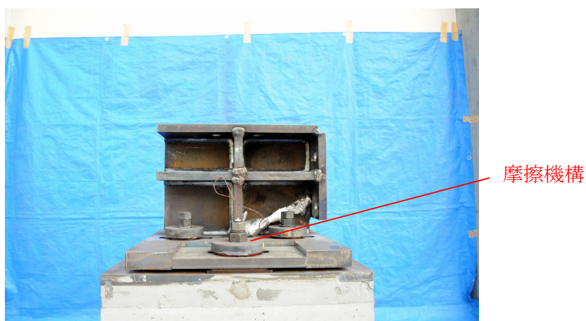
写真 5.2(b) 支承実験 試験体(支承部)
