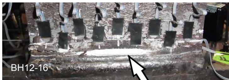
梁フランジ中央の溶接止端部から延性亀裂が進展
