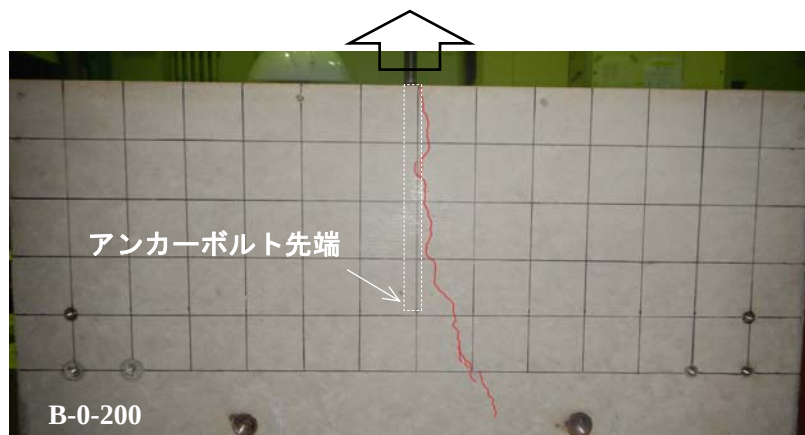
(b) 付着破壊 ( \theta=0 度)
