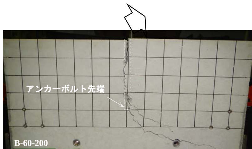
(f) コーン状破壊 ( \theta=60 度)
