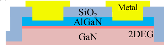
図 2.2 TLM 測定を行うためのデバイス作製手順
