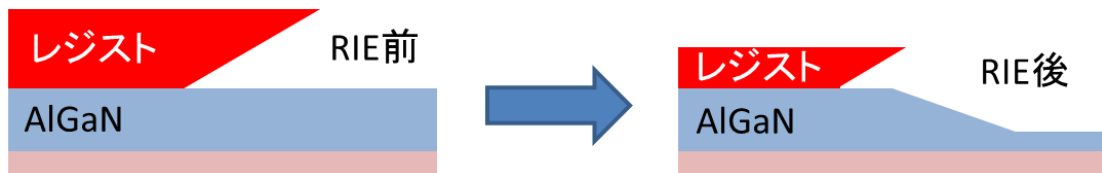
図 5.20 凹凸構造エッジ部がブロードになる原因の概念図
