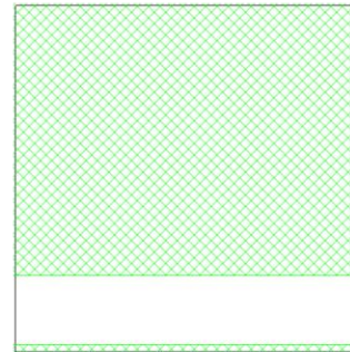
(d) アライメントマークのみをエッチングするマスク
