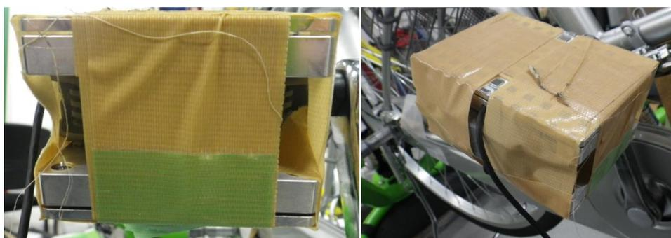
図 4. 17 ペダルとロードセルの接着部分の様子
