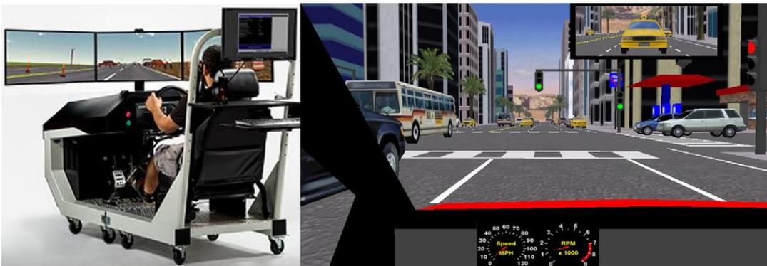
図 2.15 STISIM DriveTM と外観と運転シーン
