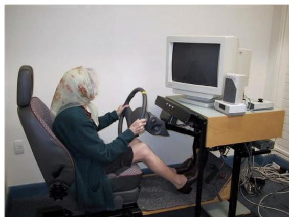
図 2.16 実験で用いられたドライビングシミュレータ
