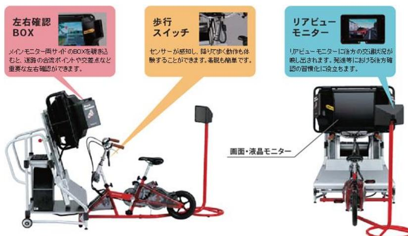
図 2.5 Honda 自転車シミュレータ(ハードの特徴)<sup>6)</sup>
