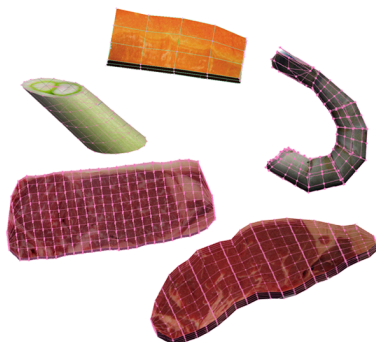
図 2.4.3 次元 CG による食材メッシュモデル. 左下は霜降りの牛ステーキ : MBS, 右下は赤身の牛ステーキ : LBS である.
