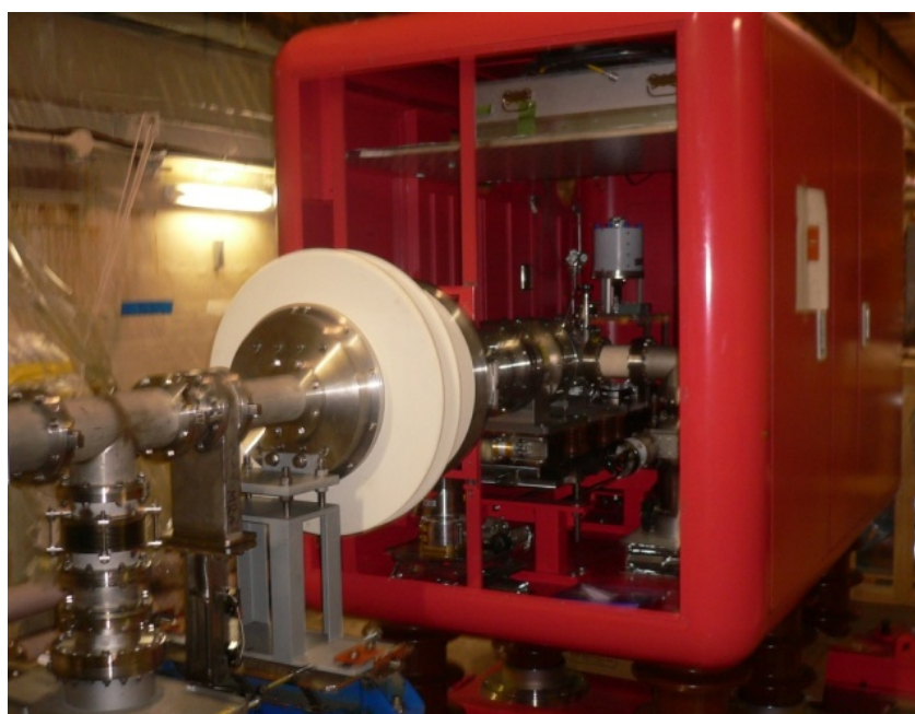
図 6-3 高電圧プラットフォーム外観 (手前：リング側、内部に ECR イオン源が収納されている)
