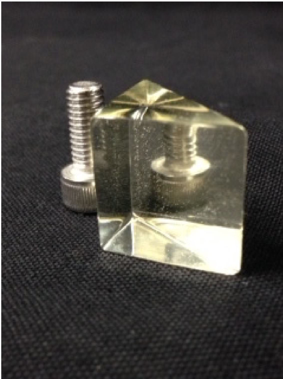
図 6.8: 3Dプリンターを用いて作製した直角プリズムの写真。表面を研磨したことで全反射の様子がはっきり確認できる。
