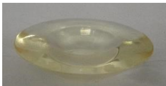
図 6.7: 全反射型カプラーと屈折透過型カプラー。上方から入射した中空ビームを下方へ導波する。
