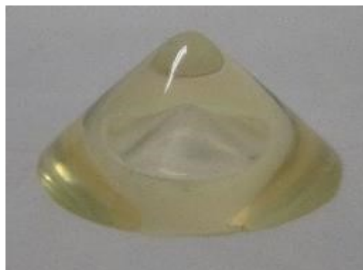
図 6.7: 全反射型カプラーと屈折透過型カプラー。上方から入射した中空ビームを下方へ導波する。
