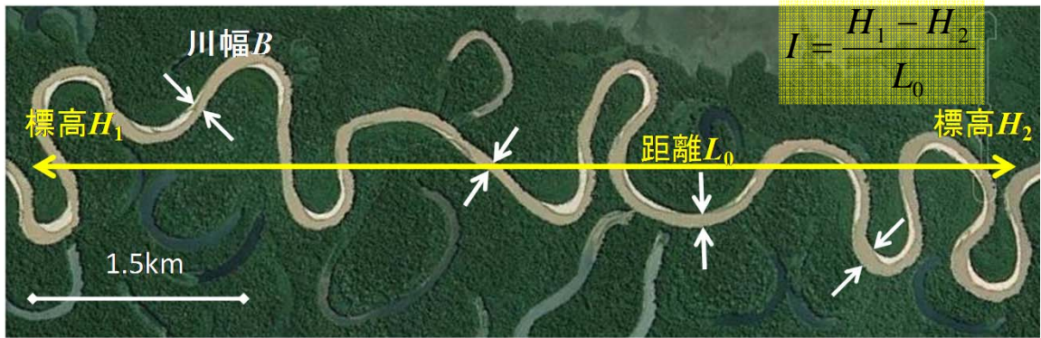
図2-6 川幅と縦断河床勾配の解析例
