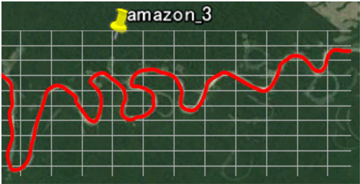
図2-11 蛇行軸線の設定の一例(アマゾン川-3)
