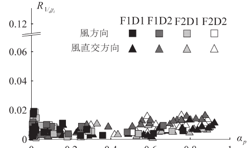
図 C 最適分布におけるダンパーの損傷分布の理論値と時刻歴解析結果との平均誤差
