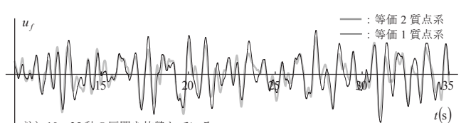
図17 主系の変位時刻歴の一例 ( \mu = 0.2 ; 最適同調時)
