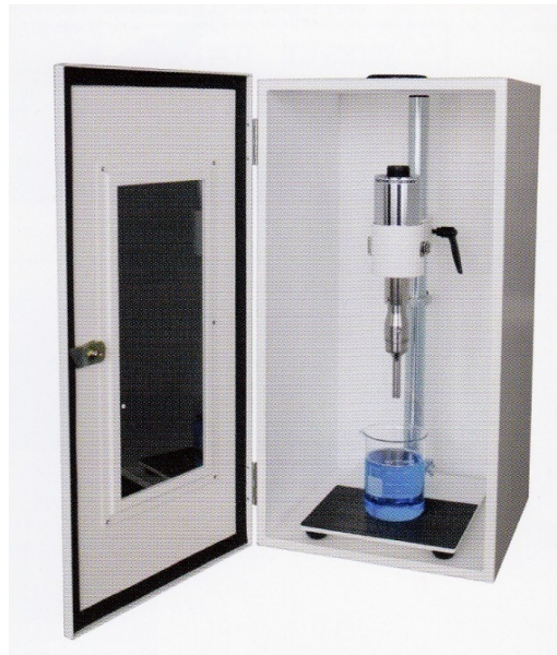
写真 5.3 実験に使用した超音波振動機
