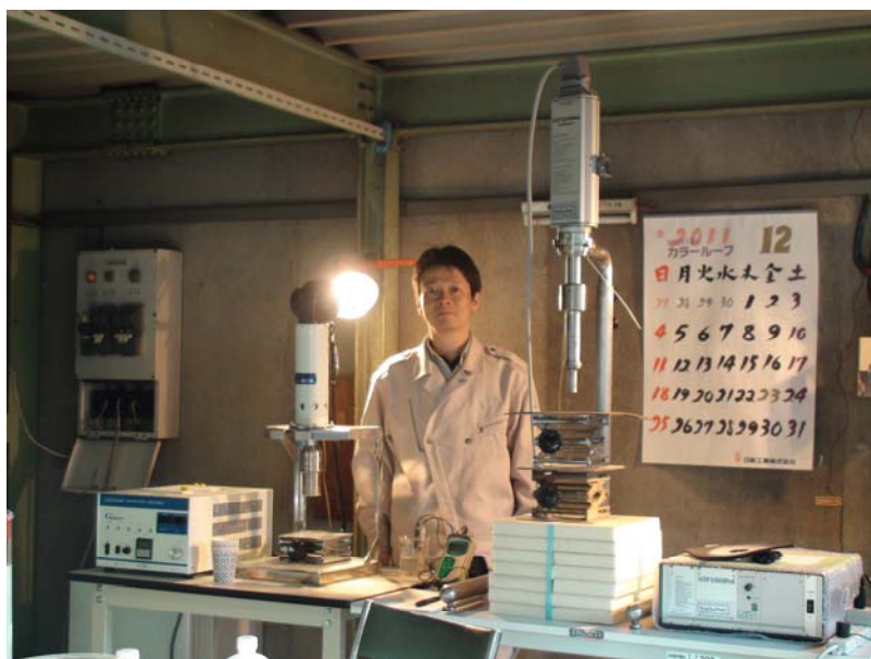
写真 6.2 実験に使用した超音波振動機
