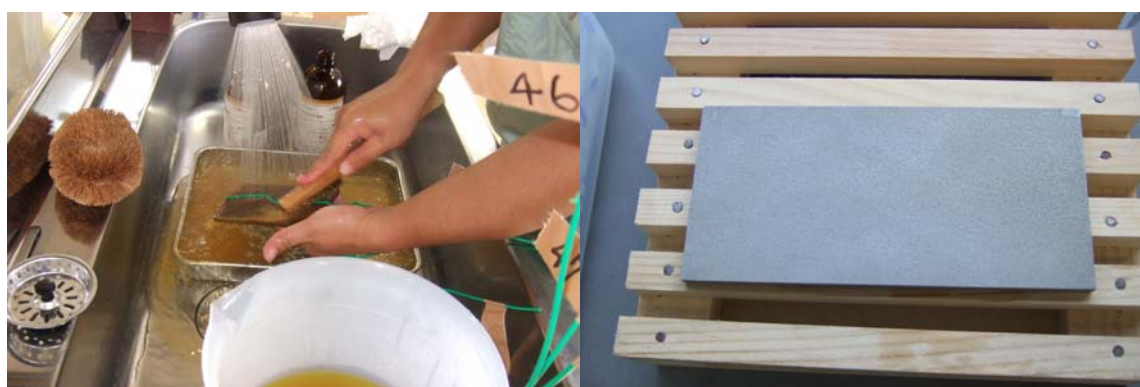
(3) 塩酸から出して鋼材表面を洗浄
