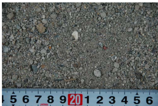
③ \phi 50mm ホーン処理後 (密度:2.32 吸水率:8.19%)
