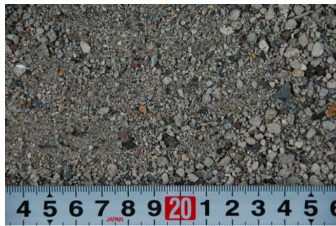
② \phi 22mm ホーン処理後 (密度:2.35 吸水率:7.13%)
