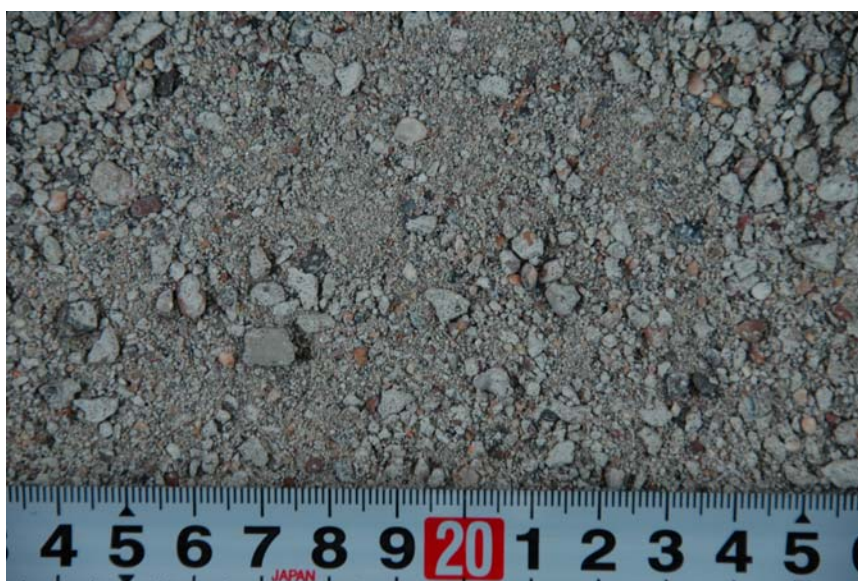
② \phi 22mm ホーン処理後 (密度:2.31 吸水率:10.19%)
