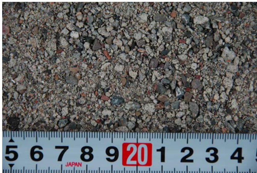
② φ22mm ホーン処理後 (密度:2.42 吸水率:6.77%)
