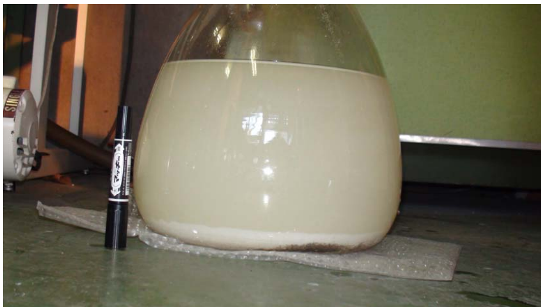
写真 6.5 分離した硫酸溶液内に析出した石膏
