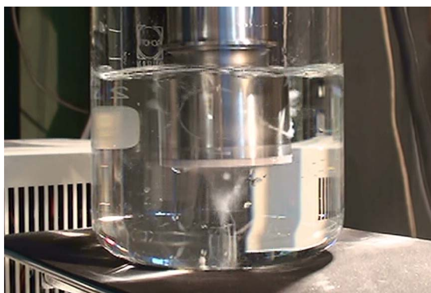
写真 6.8 \phi 50\text{mm} ホーンのキャビテーションの状況
