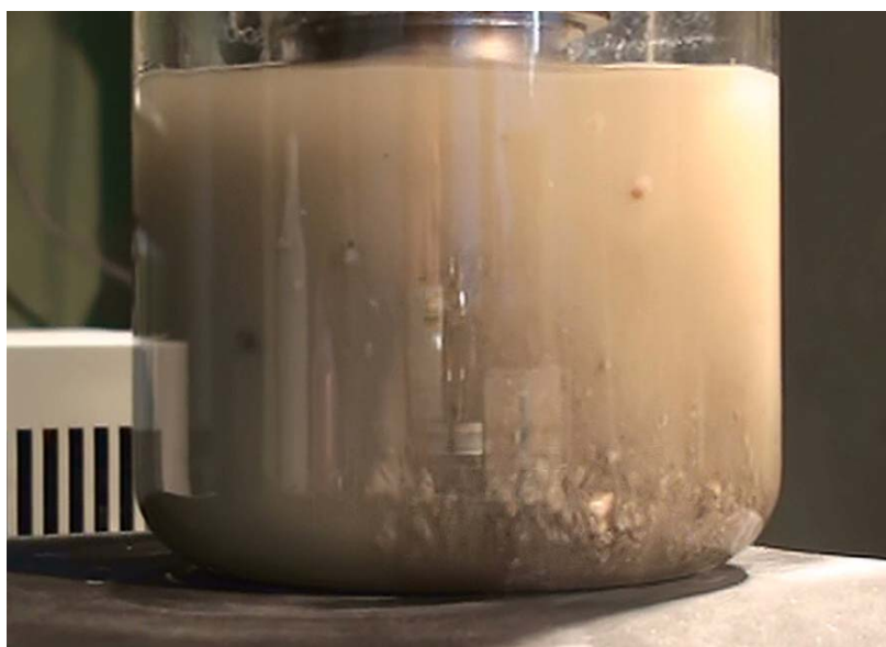
写真 6.4 \phi 50\text{mm} ホーンでの細粒分の動き
