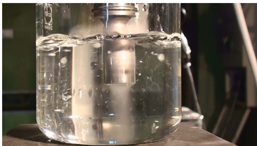
写真 6.7 \phi 22\text{mm} ホーンのキャビテーションの状況
