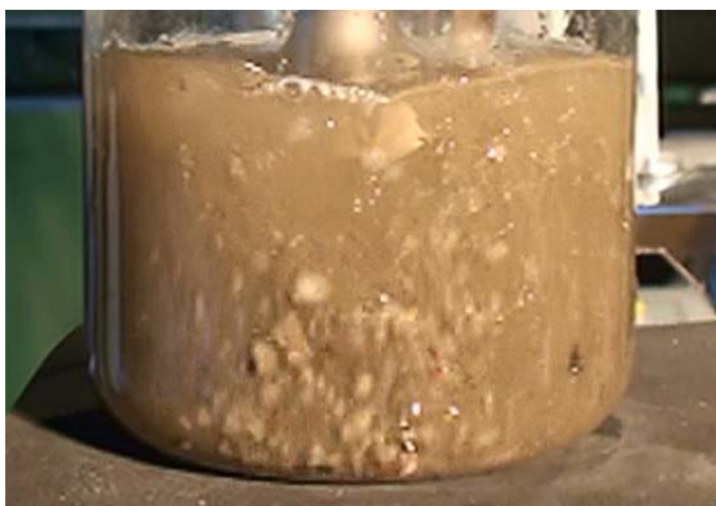
写真 6.3 \phi 22\text{mm} ホーンでの細粒分の動き
