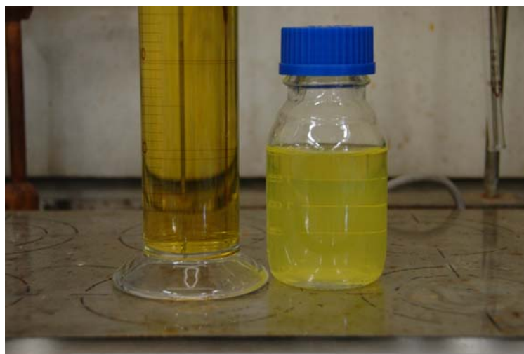
写真 2.4 廃コンクリート微粉末を溶解した後の塩酸溶液
