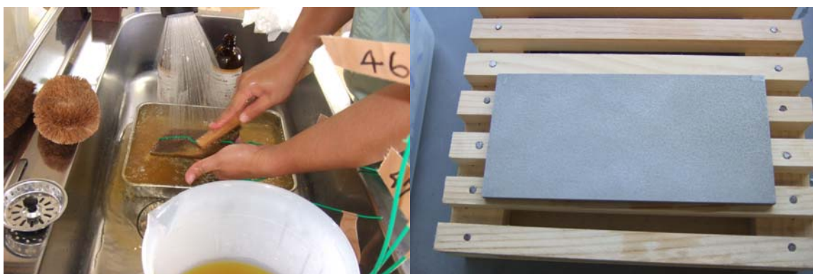
(3) 塩酸から出して鋼材表面を洗浄
