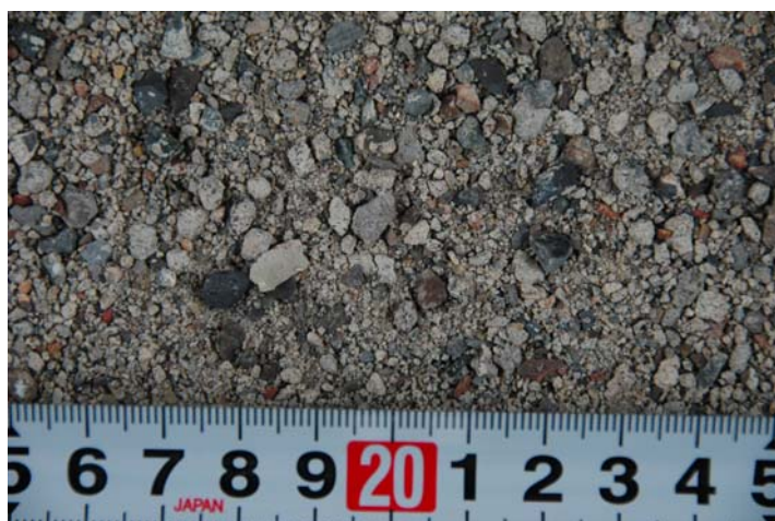
② \phi 22mm ホーン処理後 (密度:2.39 吸水率:7.41%)
