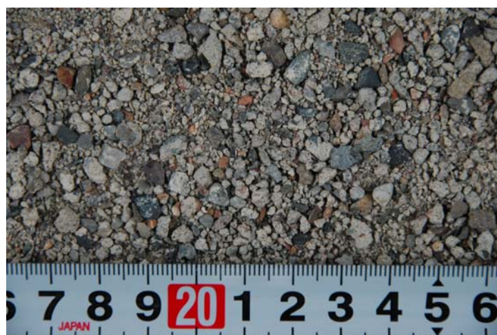
③ \phi 50mm ホーン処理後 (密度:2.40 吸水率:7.48%)
