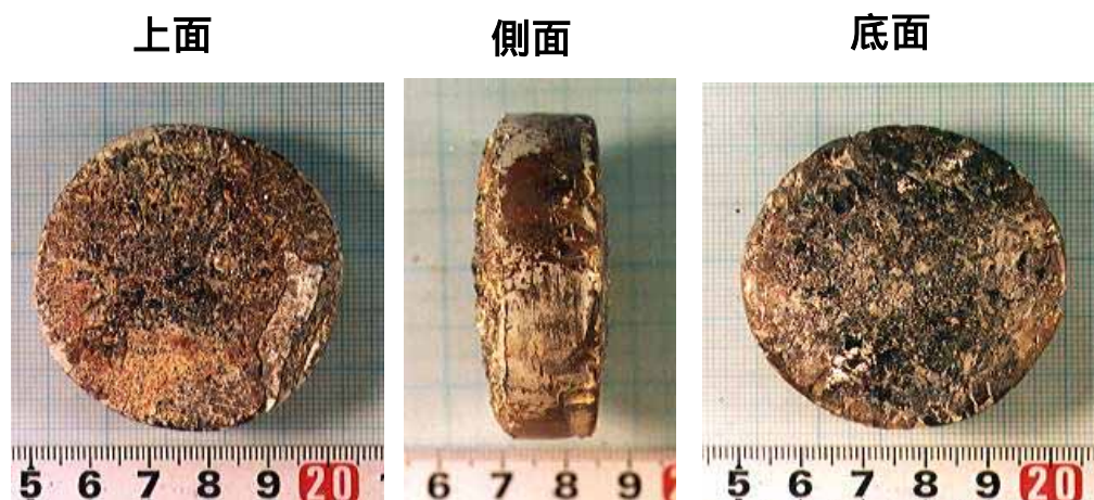
図 3-3-3 一般的な下支えブリッジマン法による 多核化結晶 B
