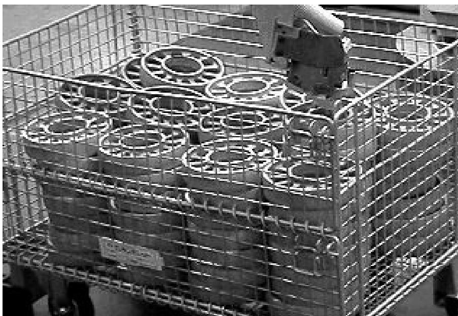
図5-11 段積み状態の部品を把持
