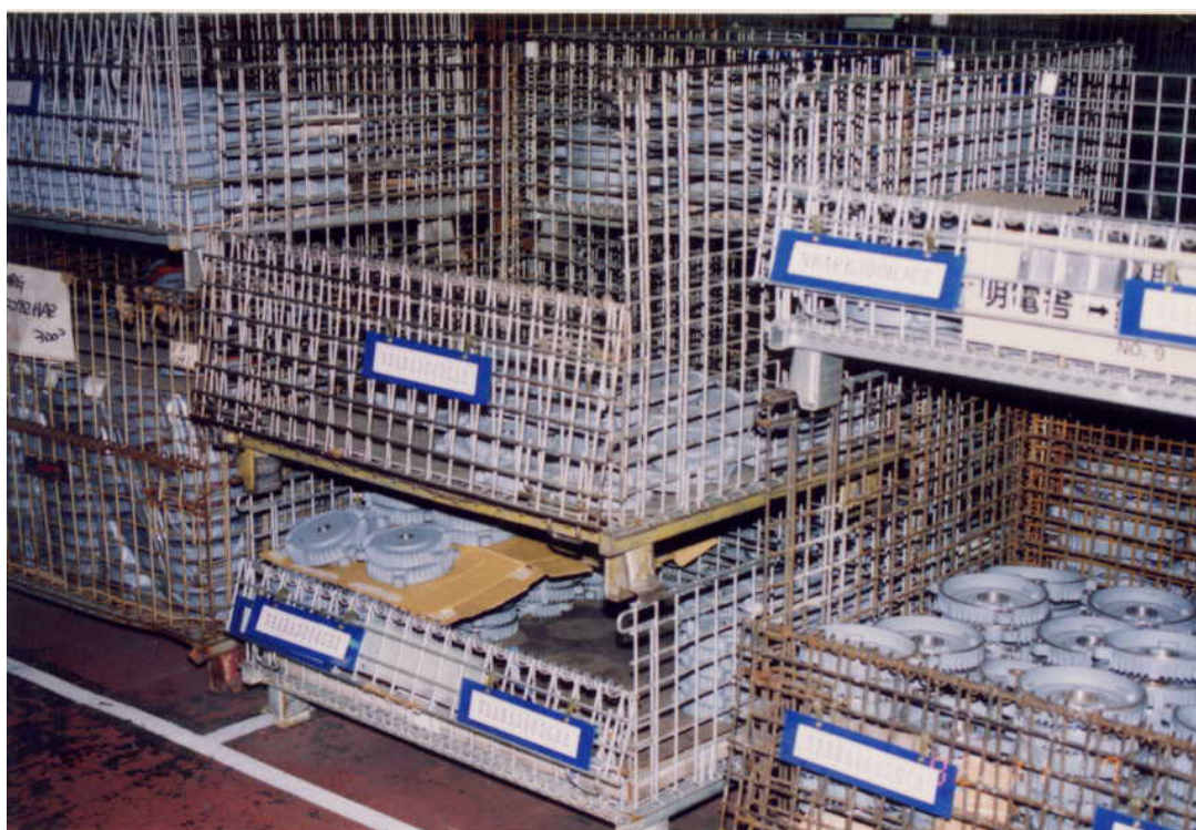
図1-3 モータ部品のカゴ型パレットの倉庫
