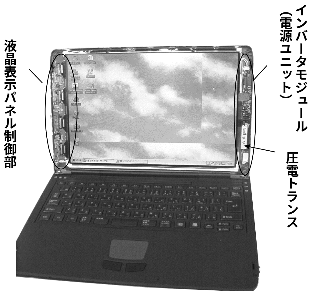
Fig.1-4 ノート型パーソナルコンピュータの液晶表示部の分解写真．圧電トランスのみ自社製素子に載せ換えてある．
