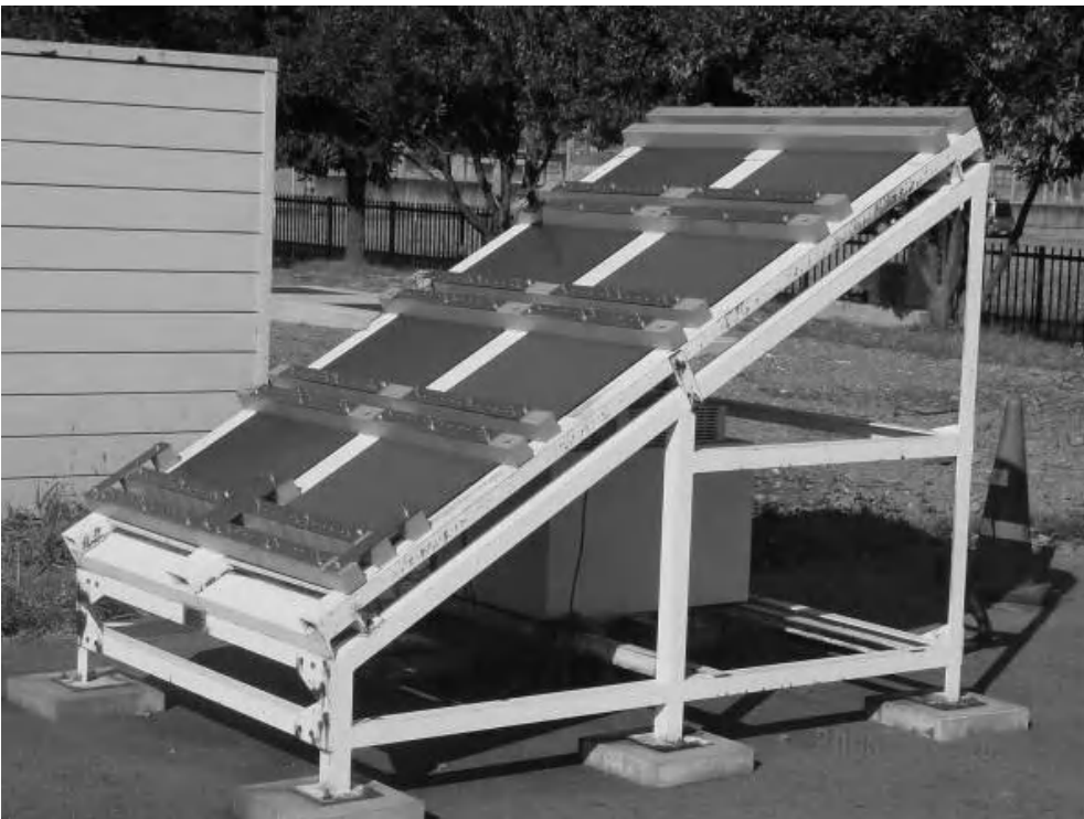
写真 1-3-1 K a r p a t i 氏開発の動暴露試験機
