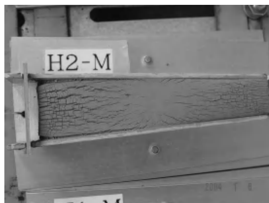
写真2-2 表面ひび割れの例
