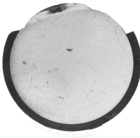
図6.10 電極外縁部破壊素子
