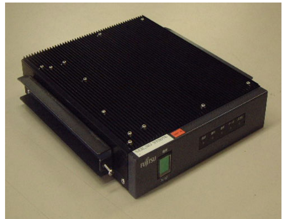
図 3-32 今回実用化した ARIB STD-39 準 拠バーストモード移動機
