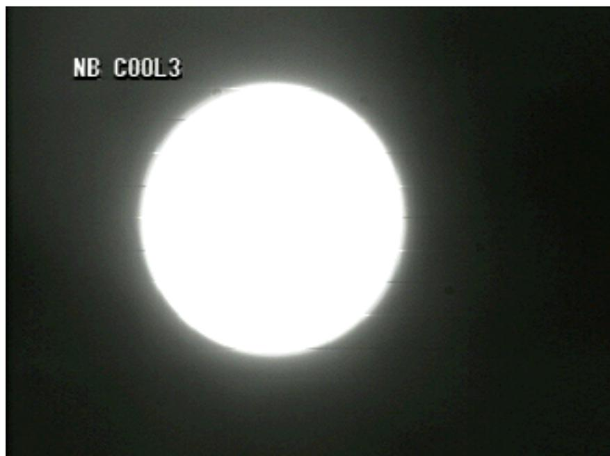
Fig.3.7-1 安定して浮遊溶融する Nb 試料
