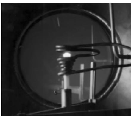
Fig.1.2-4 電磁浮遊方式（左）[1-31]
