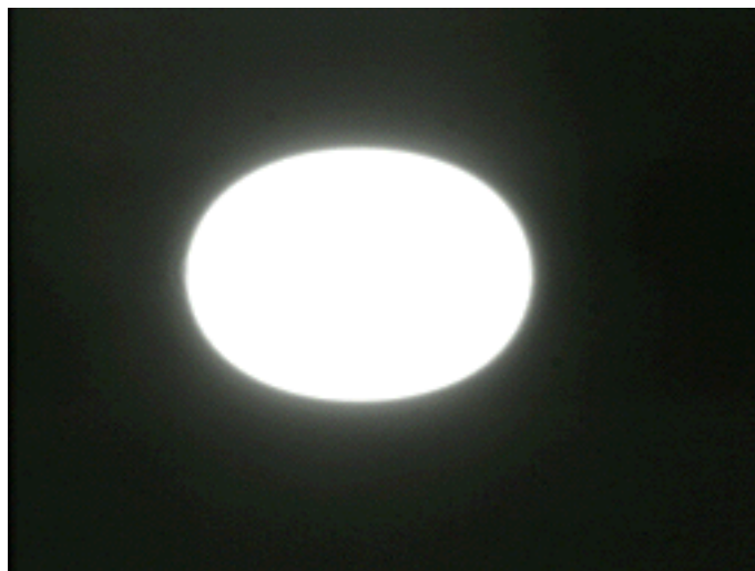
Fig.3.6-4 加熱レーザーにより回転し変形した溶融Zr試料
