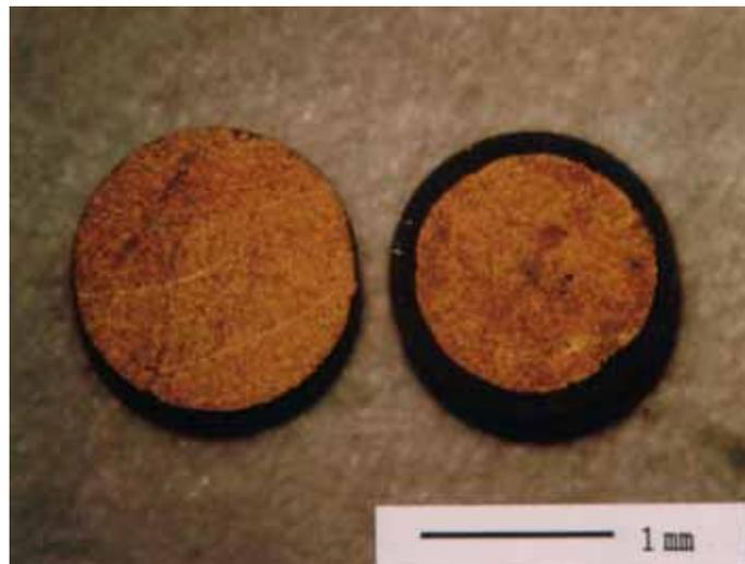
図 5-2-4 シングルプローブ用振動子の外観写真
