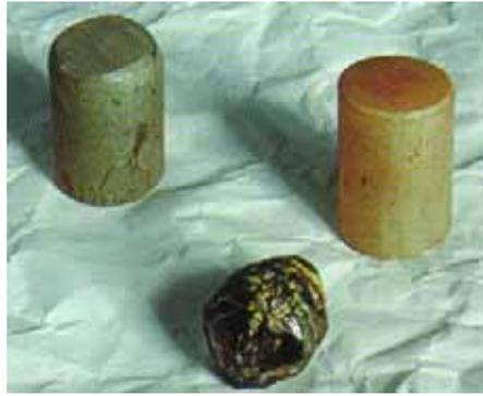
図 2-4-11 中国科学院・上海珪酸塩研究所による圧電単結晶（同研究所カタログより）
