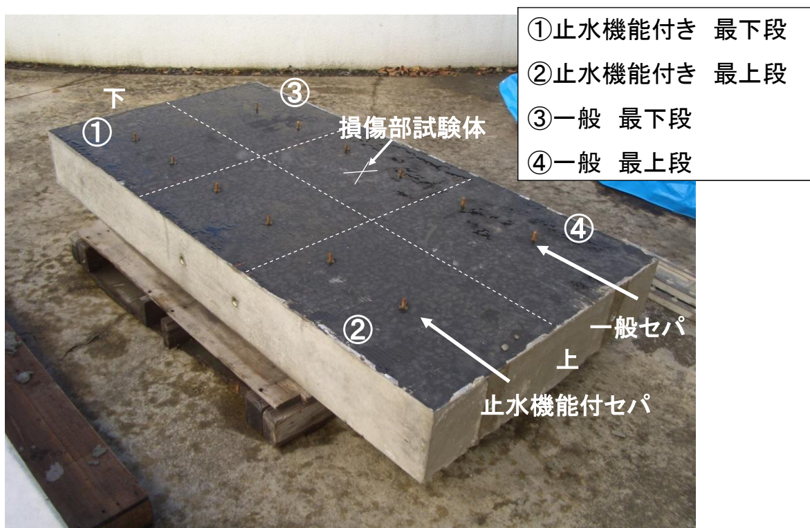
写真 5.2 鉛直打設試験体からの試験体取得位置
