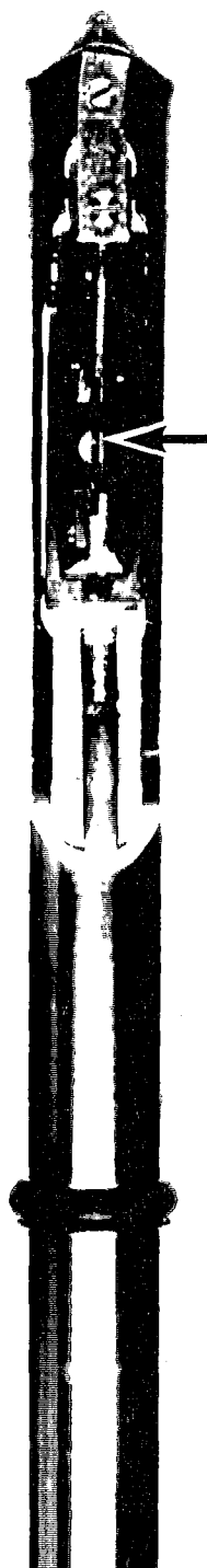
Fig.2-8 サイドエントリー型の一軸傾斜通電加熱試料ホルダー。矢印で、試料の位置を示す。
