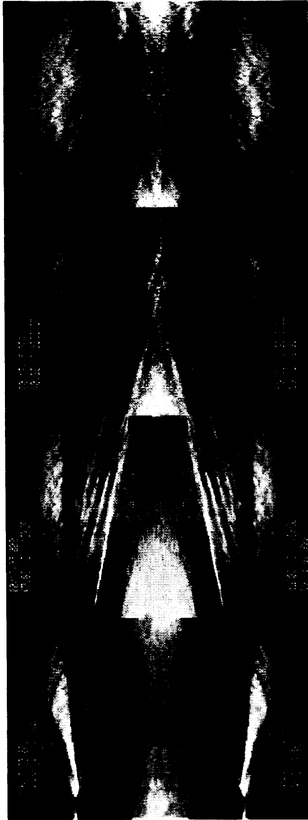
図 3.50: 実験結果から得られる超音速混合流問題の流体構造: 実験から超音速 2 流体混合領域で一定間隔に現れる微小衝撃破列 (Shocklet) と呼ばれる構造を捕らえることができる。
