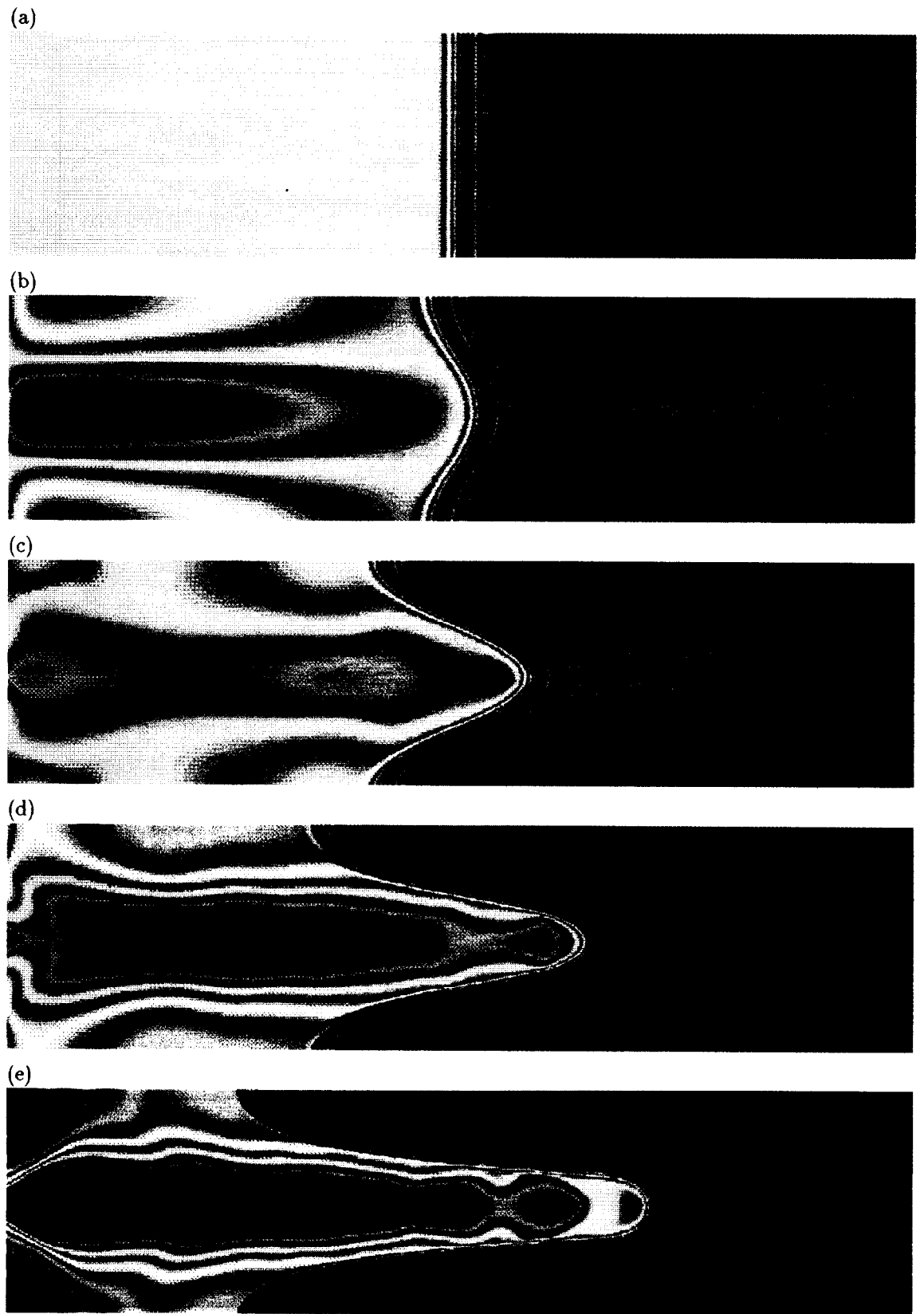
図 3.24: 三角関数を用いた擾乱によるレーリー・テラー不安定性の発達 計算空間全体に渡って擾乱が与えられるため、マッシュルーム構造が発達しにくい。(a)-(e) はそれぞれ t = 0, 0.2, 0.6, 1.0, 1.4 における密度プロファイル。
