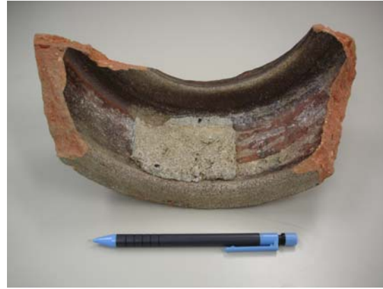
図 5.1 悪水吐暗渠跡とそこに使用された近代土管接合部のセメント様硬化体 1,2,3)
