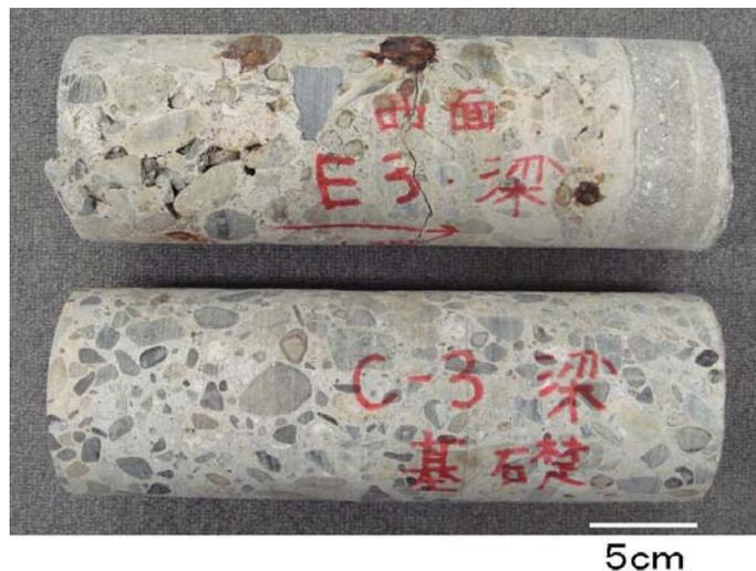
図 6.17 採取されたコンクリートコアの外観
