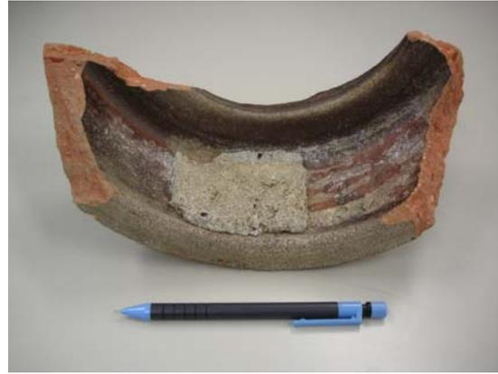
図 5.1 悪水吐暗渠跡とそこに使用された近代土管接合部のセメント様硬化体<sup>1,2,3)</sup>
