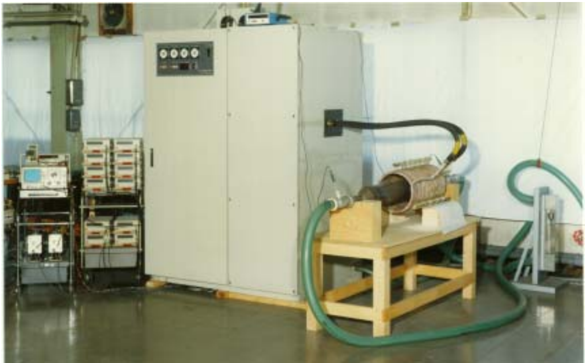
図2-4-7 試作した高周波インバータと模擬負荷装置を用いた試験状況
