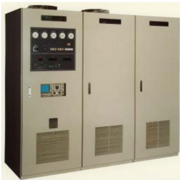
図3-2-15 電源障害試験装置 の外観
