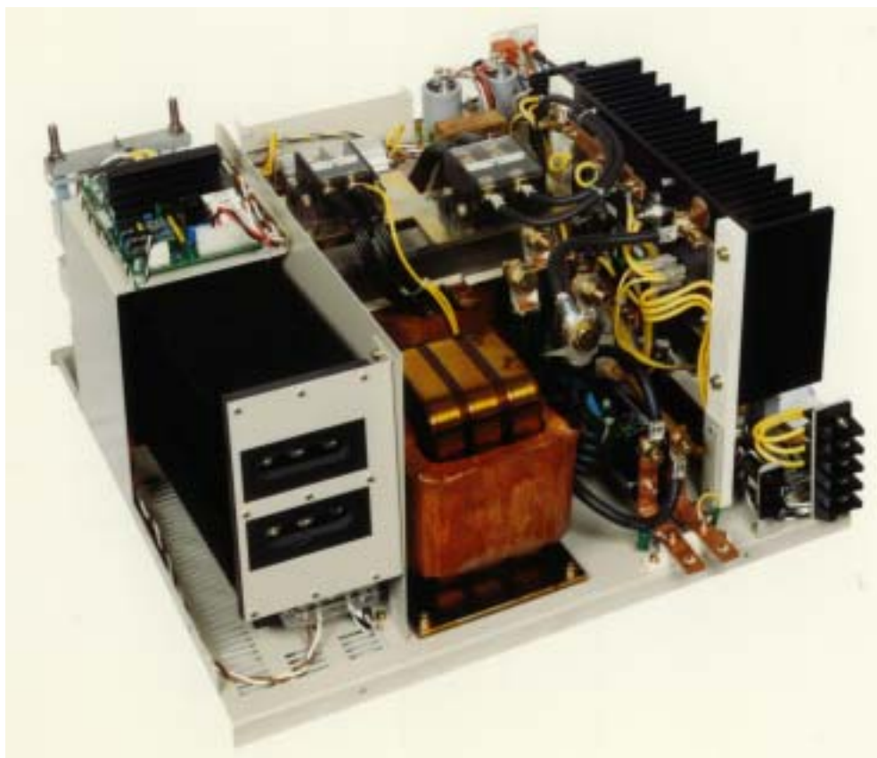
図2-5-19 試作した5kW級フライバック方式電圧共振DC/DCコンバータ外観
