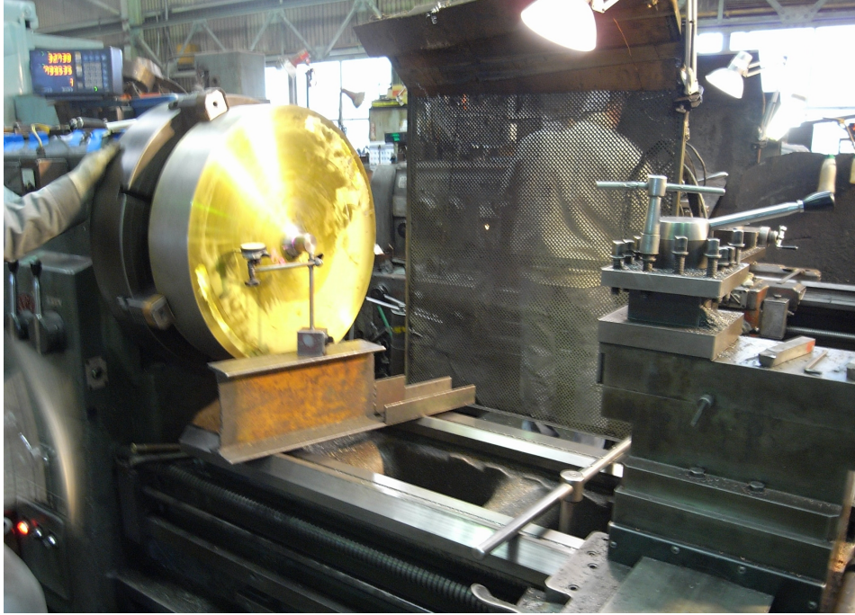
図 2.12: 旋盤でのフライホイール加工時の様子
