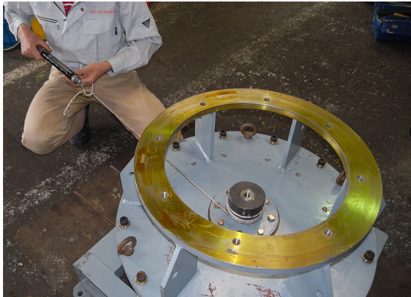
図 2.16: ばね秤による静止摩擦トルクの測定の様子
