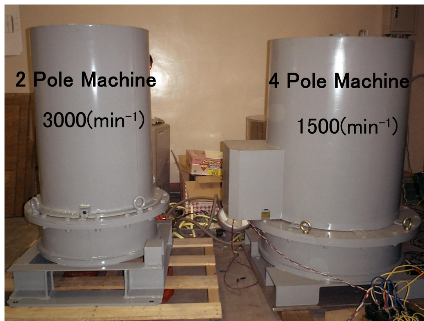
図 2.17: 完成した 10 kW/10 s , 10 kW/15s 出力フライホイール交流蓄電機の外観 (2 極機 (左) と 4 極機 (右))
