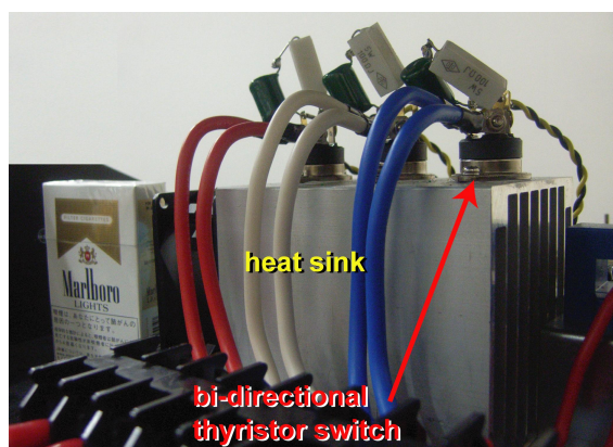
(a) 3 つの双方向サイリスタの場合 (直方体の放熱器の上面のみに 3 つの双方向サイリスタスイッチを実装)
