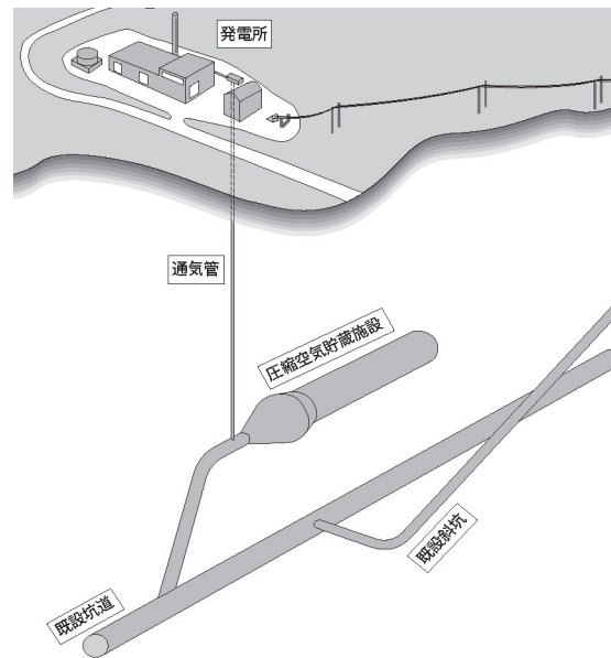
図 2.4: 圧縮空気貯蔵装置設置例
