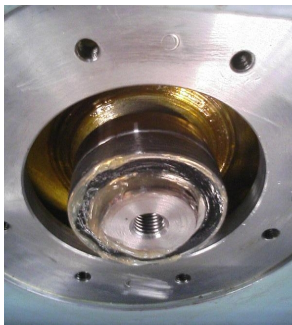
図 2.15: 下部アンギュラベアリング取り付け時の様子
