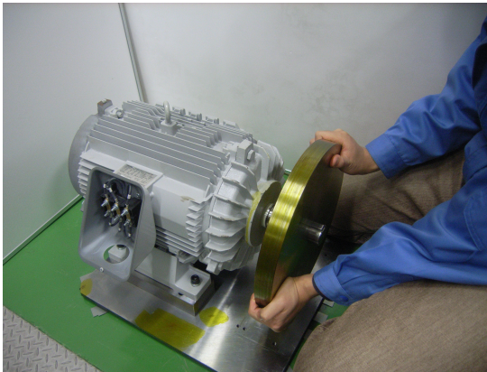
(a) 厚さ L=33 mm (ディスク 1) 取り付け
