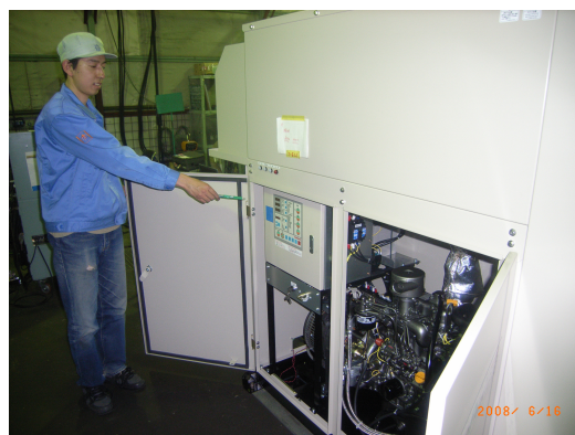
(b) 内部のエンジンと同期発電機
