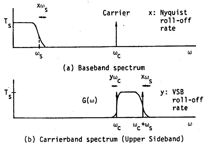
図3-2 PCM-FDM伝送方式のスペクトラム
