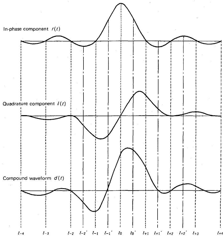
図 3-5 キャリア自動位相制御の原理
