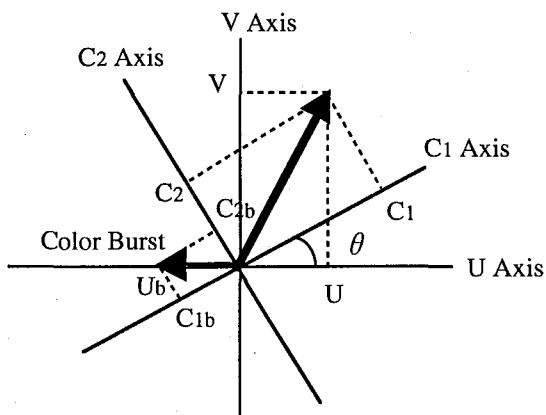
図4-2  $C_1$ 、 $C_2$ 軸とU、V軸の関係
