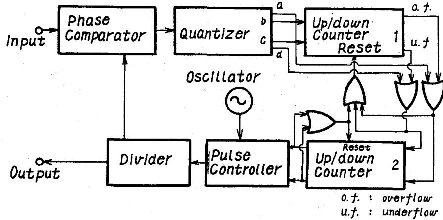
図2-4 カウンタ段数切替型DPLLの構成
