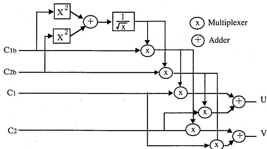
図4-3 色信号変換回路のブロック構成
