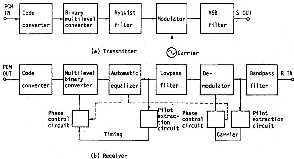
図3-1 PCM-FDM変換装置のブロック構成図
