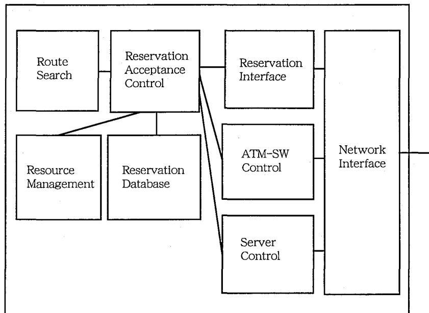
図4-20 回線設定サーバの構成例
