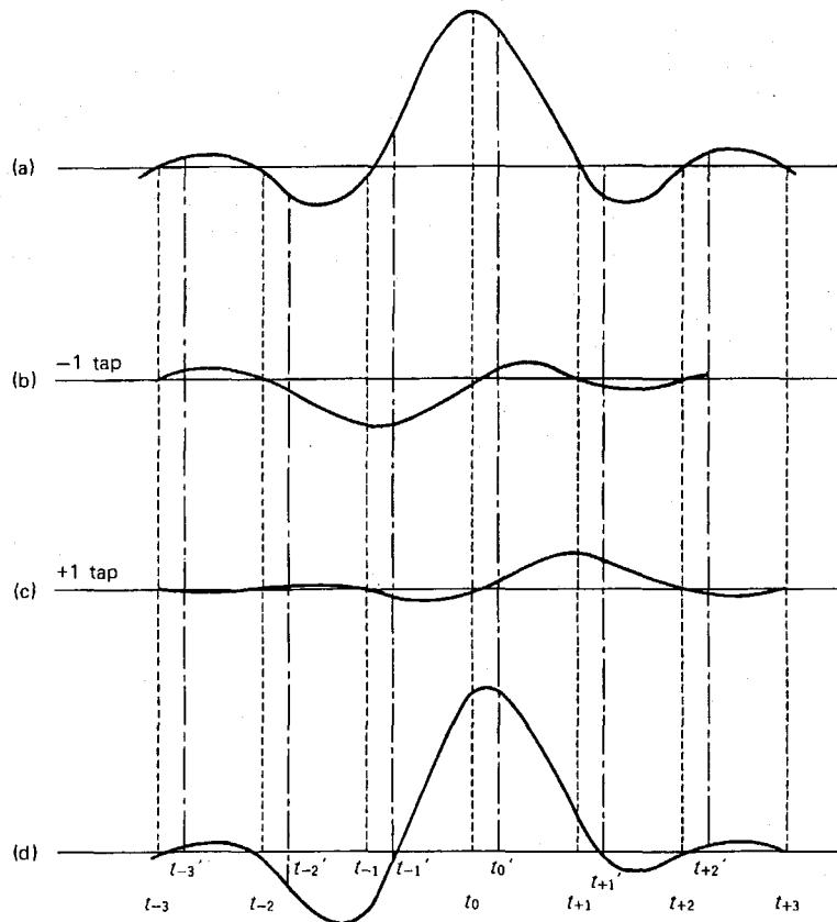
図 3-4 タイミング自動位相制御の原理
