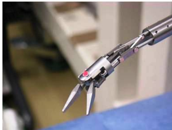
Fig. 1.17: Link-driven forceps manipulator (Arata et. al.) [28]
