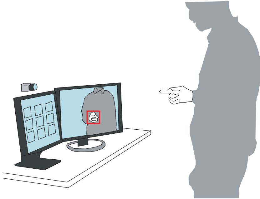
図 1.2. ハンドジェスチャ認識システムの例. ユーザの手形状や動作に応じて, リモコンを使わずに AV 機器などの操作ができる.
