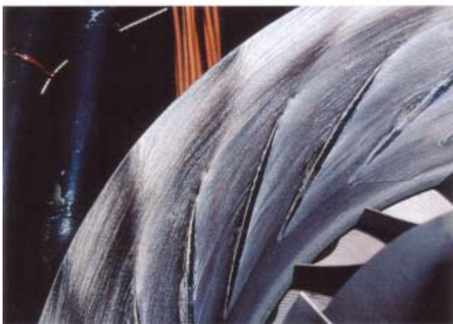
図 4-13(b) 流れの可視化結果 Q/Q_{ref}=0.88 (上:シュラウド 下:ハブ)
