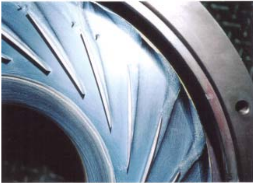
図 5-7(a) 流れの可視化結果 Q/Q_{ref}=1.18 (上:ハブ 下:シュラウド)
