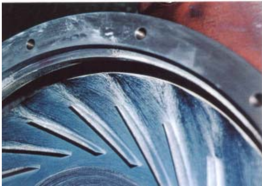
図 5-7(b) 流れの可視化結果 Q/Q_{ref}=1.0 (上:ハブ 下:シュラウド)
