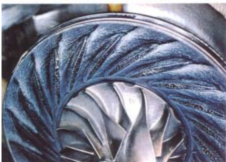
図 2-9(b) 油膜法による流れの可視化 (VD-2) 上から図 2-9(a)の 、 、 に対応
