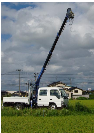
図 3.19 屋外ハイパースペクトル画像撮影システム
