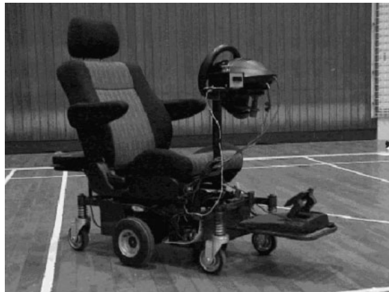
図 5.1: フォースフィードバックを実現するハンドル装置
