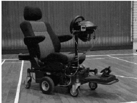
図 5.2: ハンドルとペダルを取りつけた状態での電動車椅子試作機
