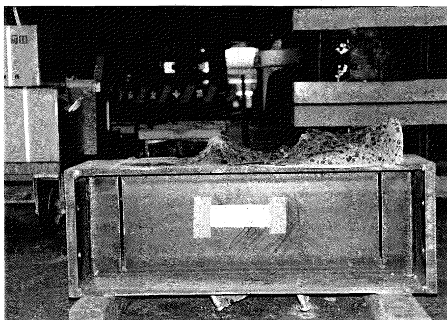
写真 A-1 (2) スタッド周辺の破壊状況
