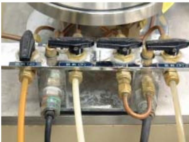
写真2.3.1.6 側圧計と間隙水圧計
