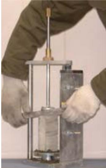
写真2.4.2 トリマーを用いた凍結砂質土
