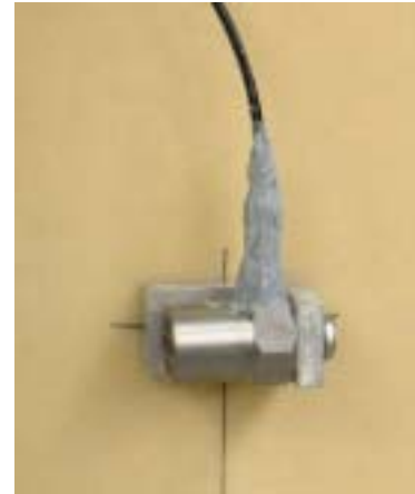
写真2.5.1 加速度計設置状況
