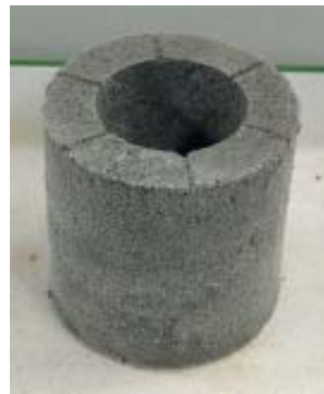
写真2.4.5 成形された中空ねじり試験用 供試体(砂質土、外径10cm、内径6cm、高さ10cm)
