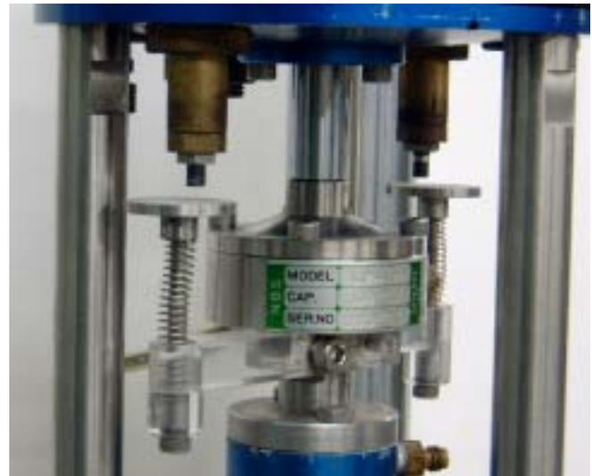
写真2.3.1.2 空気圧制御装置(微小荷重載荷用) 写真2.3.1.3 ロードセルと非接触型変位計
