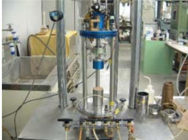
写真2.3.1.1 小型繰返し三軸試験装置のセル
