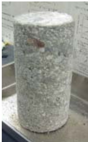
写真2.4.1 成形された三軸試験用凍結供試体(礫質土、直径15cm、高さ30cm)
