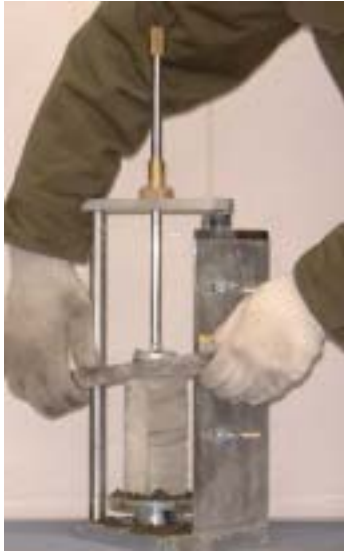
写真2.4.2 トリマーを用いた凍結砂質土 供試体の成形
