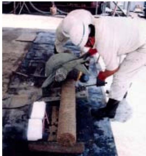
写真2.1.9 カッターによる試料切断
