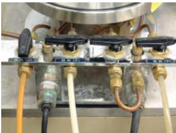
写真2.3.1.6 側圧計と間隙水圧計
