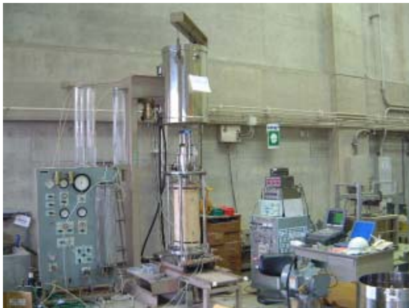
写真2.3.3.2 大型三軸試験装置の全景
