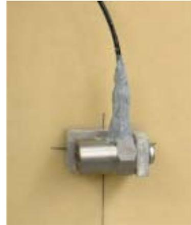
写真2.5.1 加速度計設置状況
