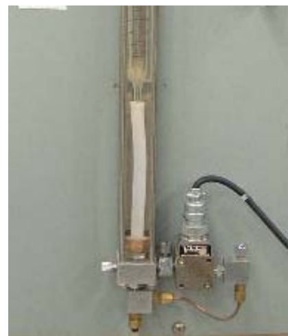
写真2.3.1.7 二重管体積計と差圧計
