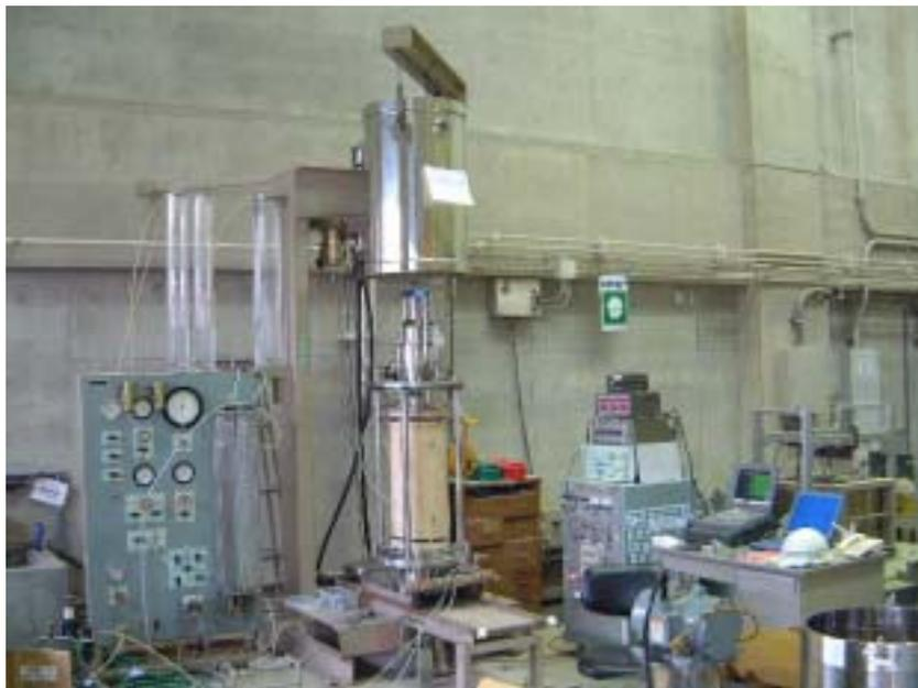
写真2.3.3.2 大型三軸試験装置の全景
