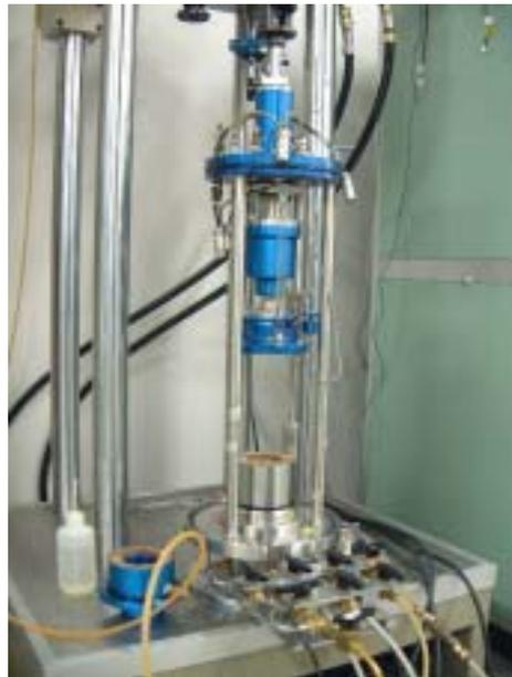
写真2.3.2.1 中空ねじり試験のセル
