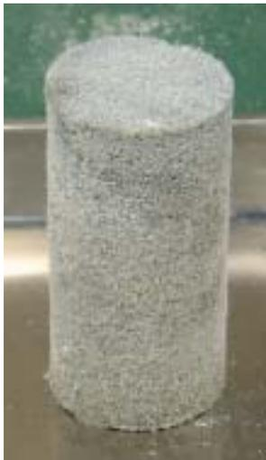
写真2.4.4 成形された三軸試験用凍結
