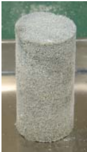
写真2.4.2 トリマーを用いた凍結砂質土 供試体の成形
