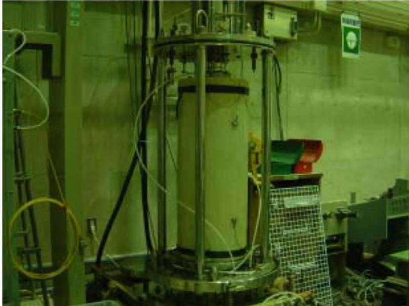
写真2.3.3.1 大型三軸試験装置のセル
