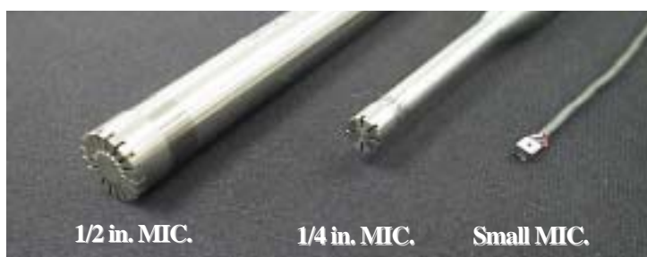
図 3.21 校正実験に用いたマイクロホン(1/2 in. (RION UC-30)、1/4 in. (RION UC-29) および計測用小型エレクトレットコンデンサマイクロホン(4 mm × 4mm × 2mm RION UC-92))
