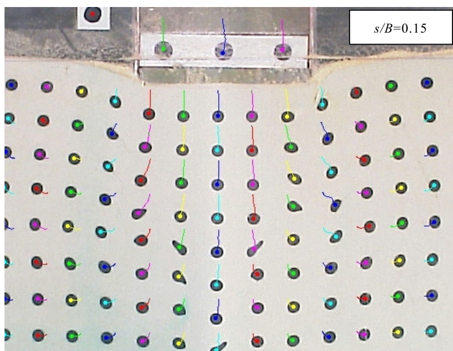
(b) case-VS1 (シートパイル基礎, L=1.0B )
