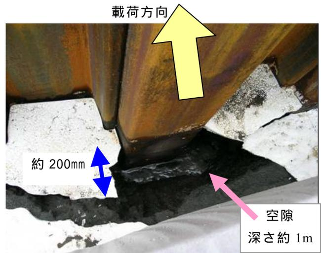
図-4.20 背面側シートパイルと地盤の空隙（試験終了時）
