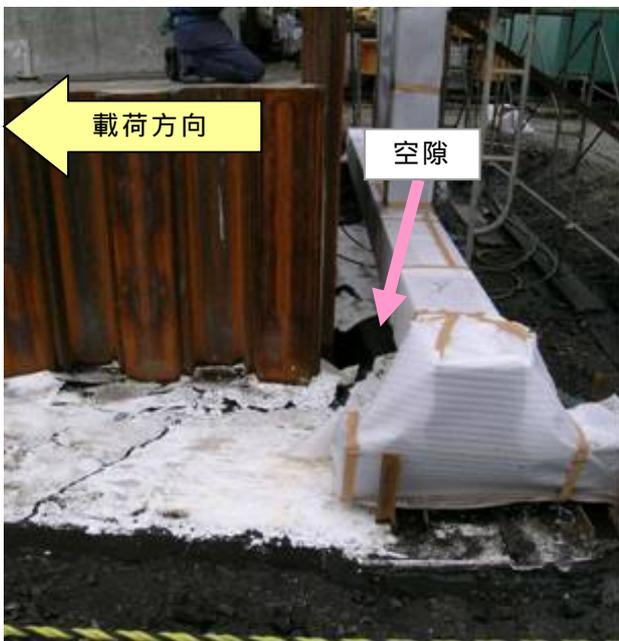
写真中の白い部分はクラックを目立たせるために設けた石膏の薄層
