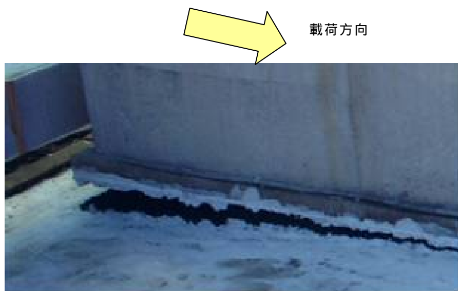
(b) P=186\text{kN} (最大荷重) 時
