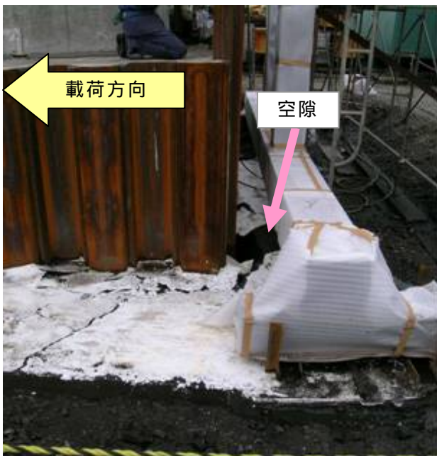
図-4.20 背面側シートパイルと地盤の空隙（試験終了時）
