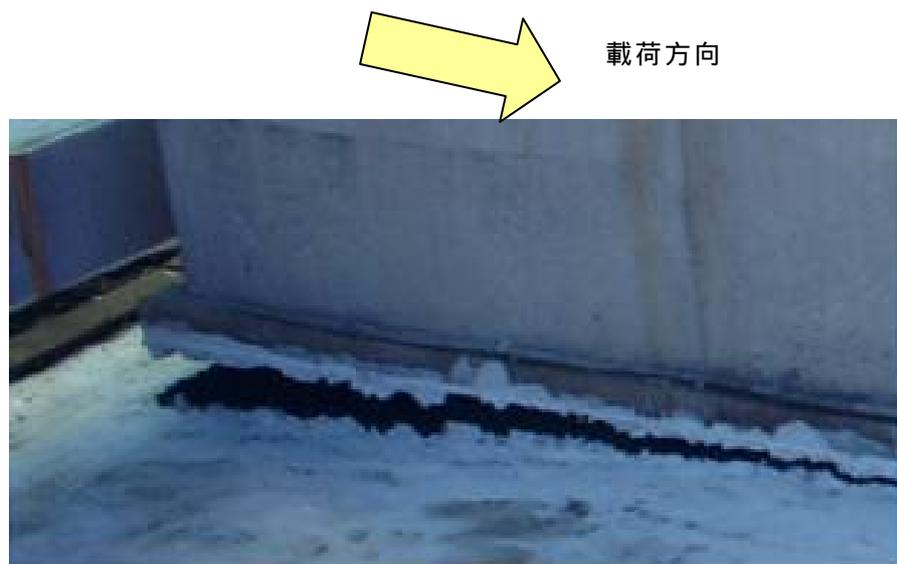
(b)  $P=186\text{kN}$  (最大荷重) 時
