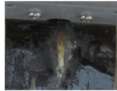
写真5.9 シート防水ジョイント部の剥離状況(両面接着シートによる接着)1/2
