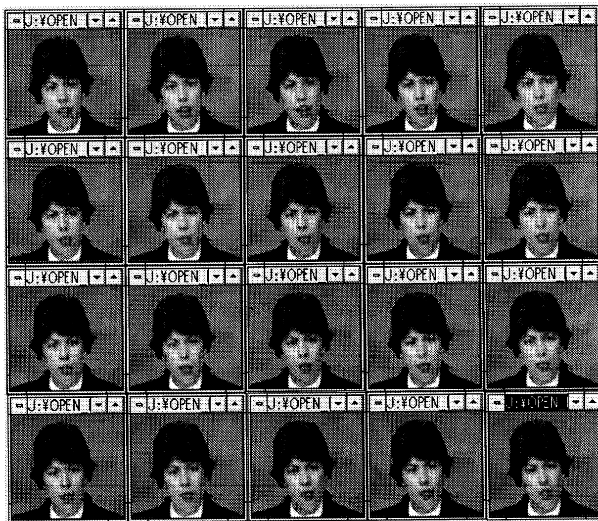
図 6.9 (c) CCITT Claire 復号画像、第40フレーム～第59フレーム Decoded images of Claire, from 40-th frame to 59-th frame
