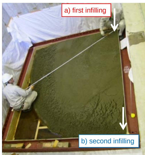
図-3.45 充填後の観察状況（左：先行充填後，右：後行充填後）
