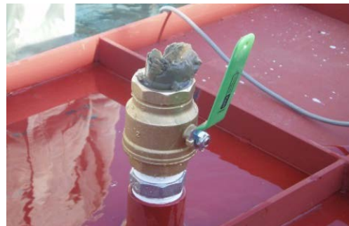
図-5.7 実験中に確認した可塑性グラウトの到達
