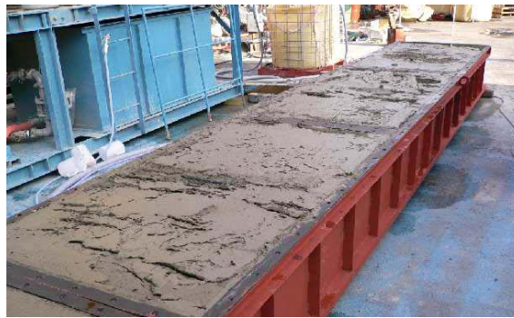
図-5.9 実験後に確認した充填状況
