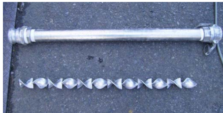
(b) 配管ミキサー（静置タイプ）内部の仕様
