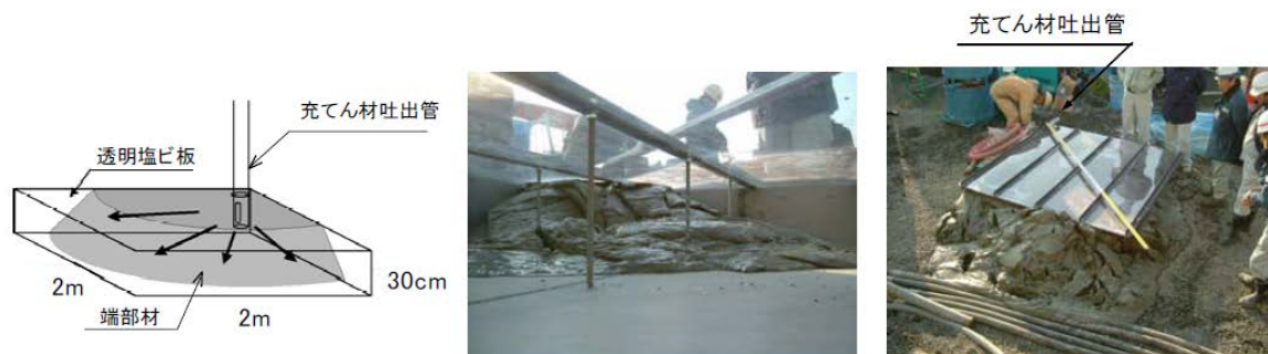
図-2.30 押し広げによる充填状況の確認実験
