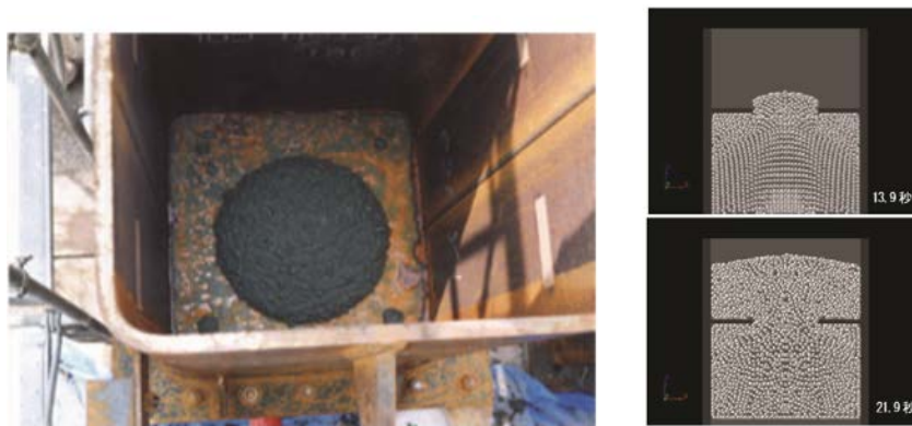
図-2.13 実験で観察されたダイヤフラム部の通過状況と解析結果
