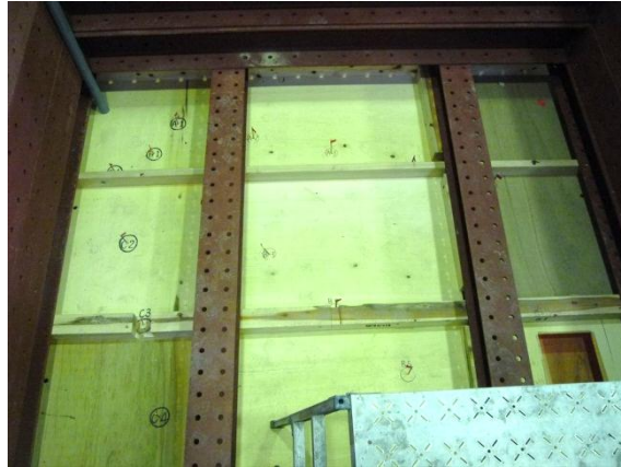
図-3.40 実験の準備状況（上面の木材パネルを山留材で固定した状況）
