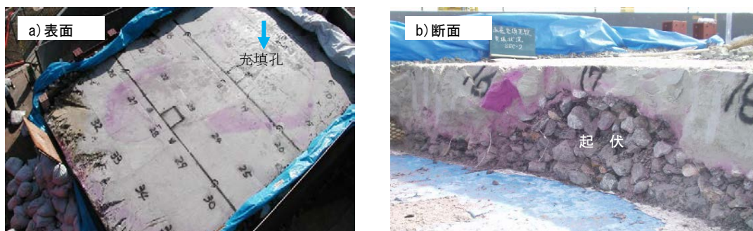
図-3.53 実験後に確認した充填状況
