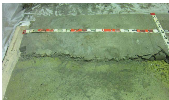
図-3.46 充填後の観察状況（写真下側が先行充填，上側が後行充填）
