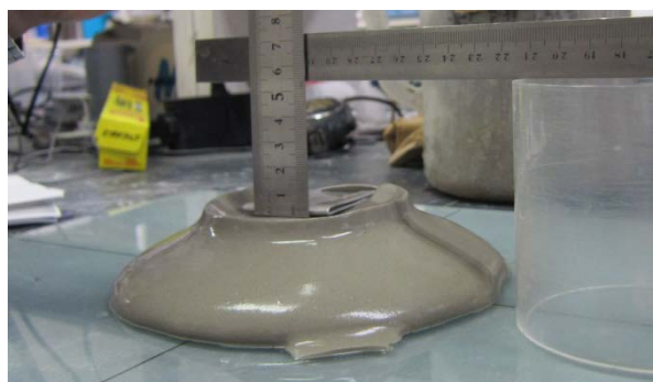
図-3.36 スランプの測定状況 (ベーンせん断抵抗 =170\text{N/m}^2 )
