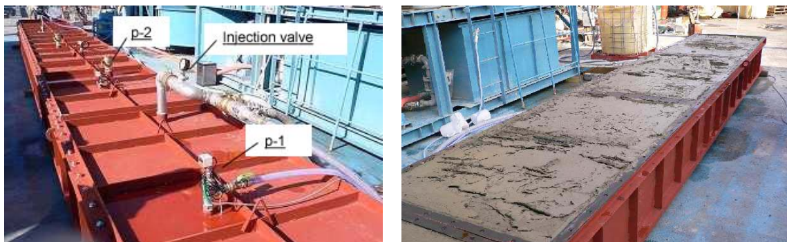
図-3.59 充填実験（上：充填実験状況，下：硬化後の上面の状況）
