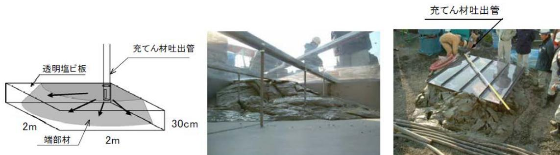
図-2.30 押し広げによる充填状況の確認実験
