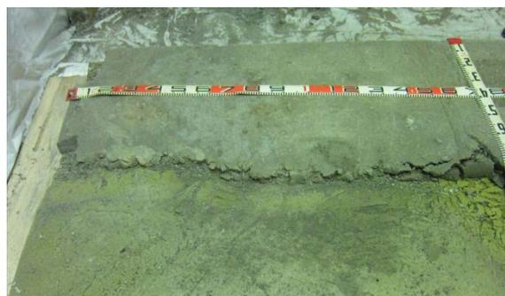
図-3.46 充填後の観察状況（写真下側が先行充填，上側が後行充填）
