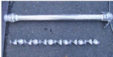
(b) 配管ミキサー（静置タイプ）内部の仕様
