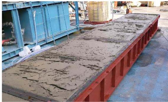
図-5.9 実験後に確認した充填状況
