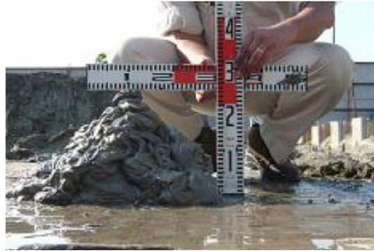
図-2.23 打設形状の確認状況
