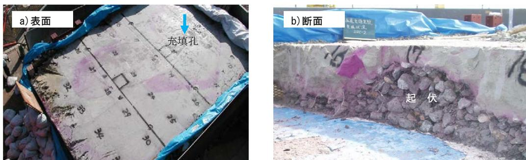
図-3.53 実験後に確認した充填状況
