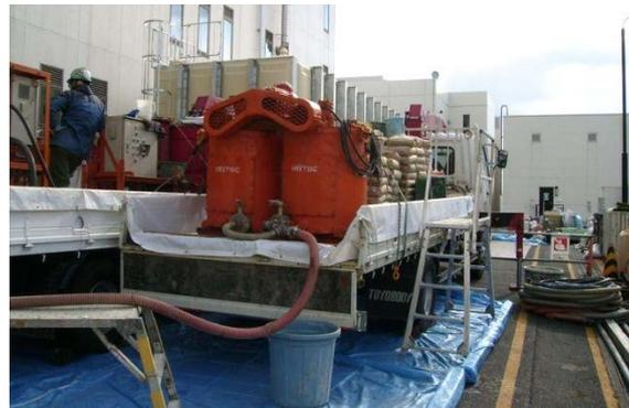
図-3.41 充填実験で用いたトラック搭載型の製造プラント
