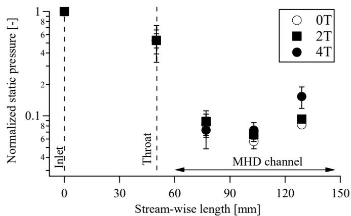
図 3-3-9 各印加磁束密度における発電機内静圧分布
