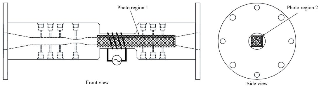
図 4-2-3 高速度カメラによる撮影領域
