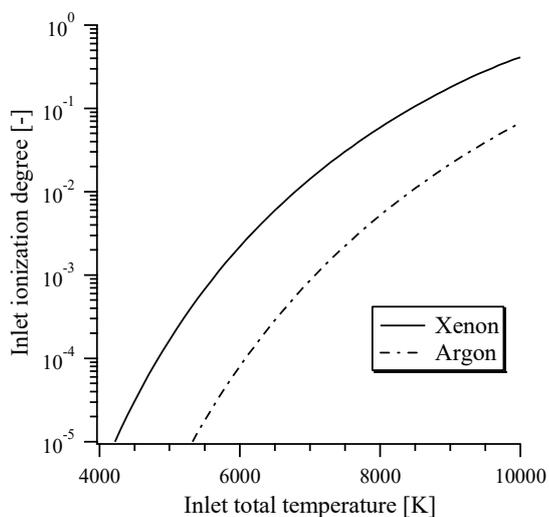
図 3-1-1 入口電離度の入口全温度依存性
