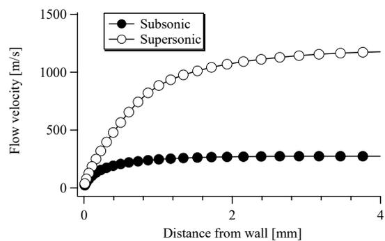
図 4-3-8 半径方向流速分布
