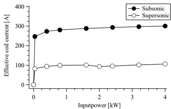
図 4-3-10 コイル電流の投入電力依存性
