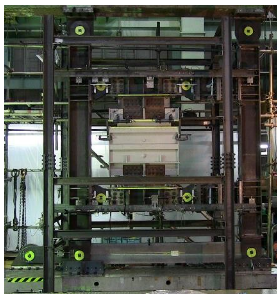
図2 左寄せフレームの試験状況
